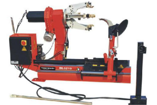
Remoção de pneus de caminhão
